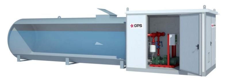
Sistema antincendio per installazione esterna, corredato di marchiatura CE in accordo con la UNI EN 1090-1, composto da serbatoio monoblocco per riserva idrica e box R60, completo di dichiarazione di resistenza al fuoco firmata da tecnico abilitato, per il contenimento del gruppo di pompaggio installato in esecuzione sottobattente.
