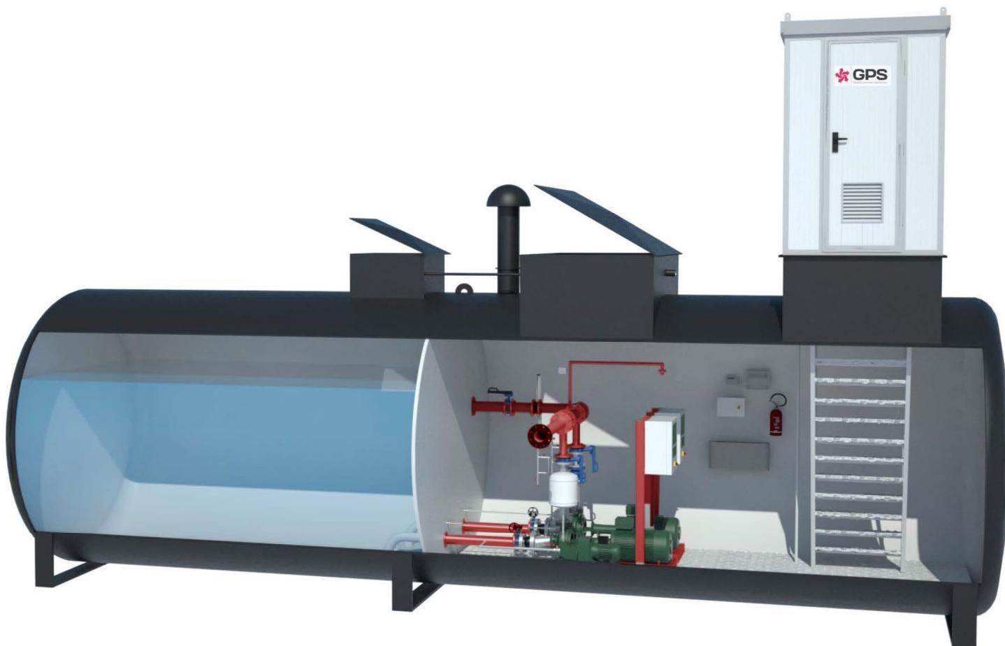
Sistema antincendio per installazione interrata, corredato di marchiatura CE in accordo con la UNI EN 1090-1, composto da serbatoio monoblocco per riserva idrica e vano tecnico integrato per il contenimento del gruppo di pompaggio installato in esecuzione sottobattente e box esterno R60 per l'accesso al vano pompe
