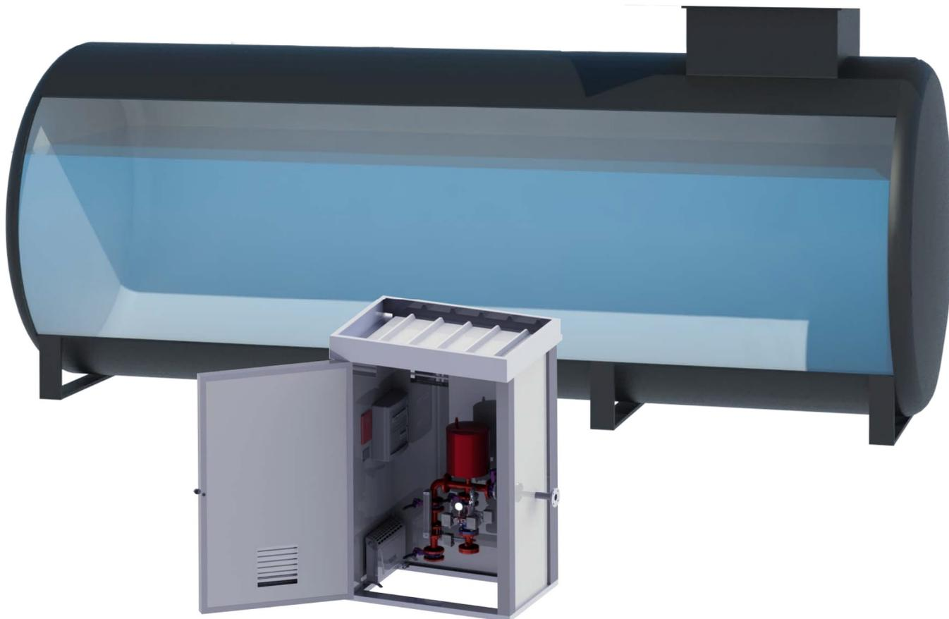
Sistema antincendio per installazione interrata, corredato di marchiatura CE in accordo con la UNI EN 1090-1, composto da serbatoio monoblocco per riserva idrica con installato il gruppo di pompaggio formato da pompe sommerse e box esterno R60, completo di dichiarazione di resistenza al fuoco firmata da tecnico abilitato, per il contenimento dei collettori di mandata e dei quadri di comando.
